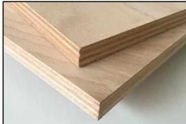
Panneau réalisé à partir de plis croisés en hêtre de 2,2 mm
