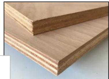
Collage MUF extérieur classe 3 conforme à la norme EN 314-2
