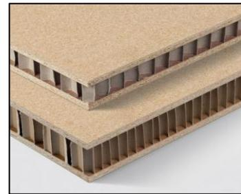
La structure sandwich des panneaux alvéolaires Eurolight se compose de deux parements en panneaux de particules minces et d'une âme légère mais robuste en carton alvéolaire. Sa légèreté (densité 330 et 265 kg/m3) n'enlève en rien sa robustesse.
