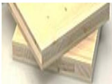
Le bois peut présenter de larges cernes, les nœuds sont sains et solidement attachés sur une face, quelques petits nœuds noirs sont admis, quelques parties tendres sont possibles, de petites différences de couleurs sont admises ainsi que de petites fissures superficielles sur les bords des panneaux.
